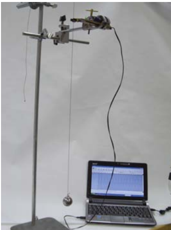
Figure 1: Imagen del dispositivo experimental utilizado para determinar el período de oscilación del péndulo. A la derecha detalle del optoacoplador.
