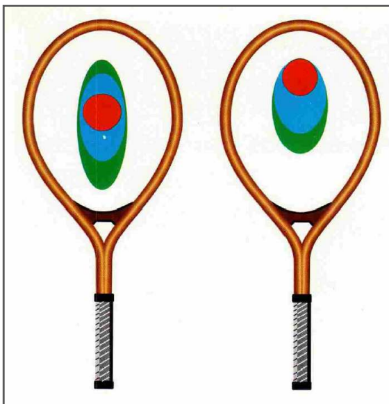
Figura 20. Representación gráfica de dos raquetas cuyos puntos de máxima potencia están situados en distinta zona: centro de la cabeza (balance neutral de la raqueta) y extremo de la cabeza (balance adelantado para golpes más potentes). Brody, H. (1995) How would a physicist design a tennis racket? Physics Today , 48, 26-31.
