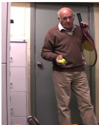
Figura 15. Rod Cross sujeta una raqueta por la empuñadura con dos dedos mientras golpea con una bola la zona encordada para buscar el nodo de vibración. Brody H, Cross R and Lindsey C. The Physics and Technology of Tennis .
